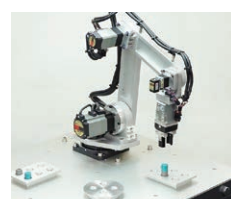
オリエンタルモーター製品で内製した垂直多関節ロボット
