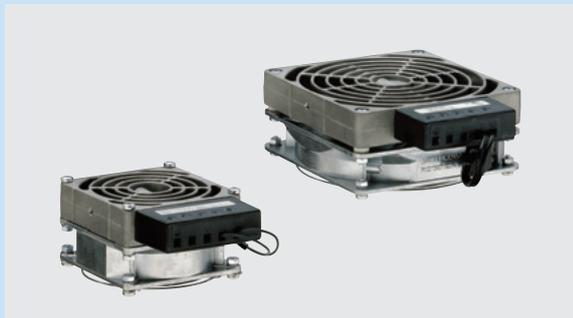
シーズヒーターに放熱板、プロペラファンおよびフィンガーガードを組み付けた制御盤ヒーターユニットです。ヒーターの熱を温風として筐体内に拡散させることができます。筐体内の結露・高湿度対策、寒冷地での凍結・低温対策に使用できます。
