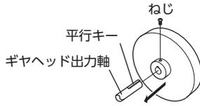
**重要** ギヤヘッド出力軸にハンマーなどで強い力を加えないでください。出力軸や軸受が破損の原因になります。
