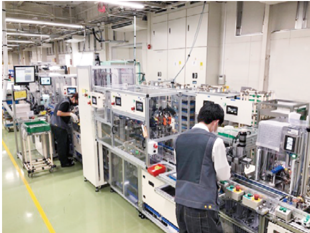
自動化と人の技能を組み合わせたモーター組立ライン
