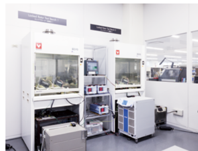
ローター拘束試験 (製品安全試験所内)
