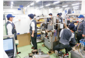
自主保全のステップに基づき、研削盤の総点検を実施
