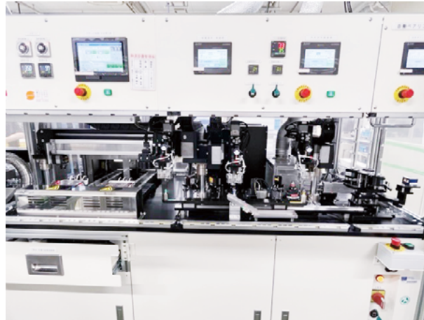
ボールベアリング接着自動化ライン
