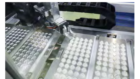
スカラロボットによる小物部品のピッキング グリッパの電流値を制御して、部品が傷つけない力加減で掴む
