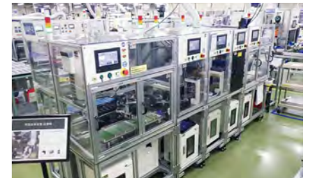
スカラロボットが接着作業を担う自動化ライン ロボットの動きが見やすいように正面パネルを透明にするなど、設備外観も意識
