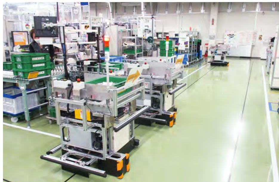
生産工程間をつなぐAGVで、モノの搬送を自動化
