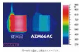
同一条件運転時のモーター外被温度
