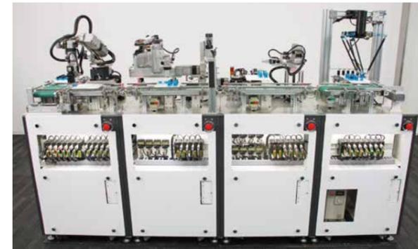
左から「ワーク投入・整列」「ワーク組立・圧入」「ワーク外観検査」「ワーク分解」デモ機
