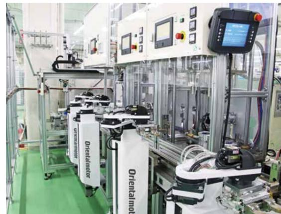
鶴岡西事業所の内製ロボットによる自動化ライン
