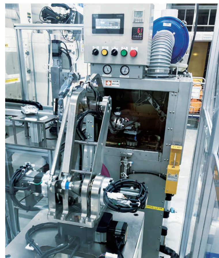
内製ロボットによるワーク搬送(能代)
