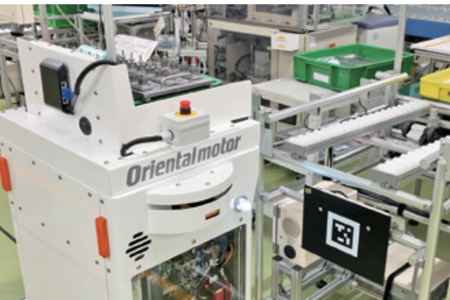
高松香西事業所のAGV搬送。 対象ラインへAGVが必要部品を運搬し、自動でラインへ投入する
