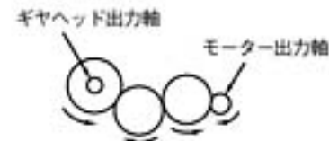
●モーター軸と逆方向の場合の例
