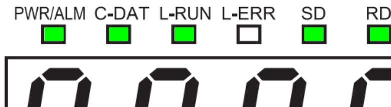
RS-485通信で接続するドライバ台数分の「RS-485 LINK STATUS」LEDの表示を確認してください。
