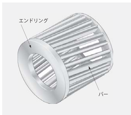
図4 ロータのバーとエンドリング
