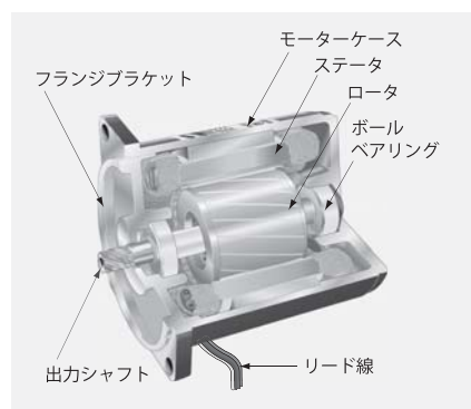
図2 インダクションモーターの構造
