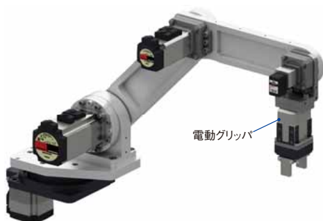
図1 グリッパの用途例 (アームロボット)
