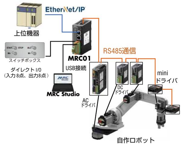
図 10 MRC01 のシステム構成
