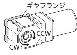
**重要** モーターの回転方向は、モーターが完全に停止してから切り替えてください。運転中に回転方向を切り替えると、回転方向が切り替わらなかったり、切り替わるまでに時間がかかりたりすることがあります。
